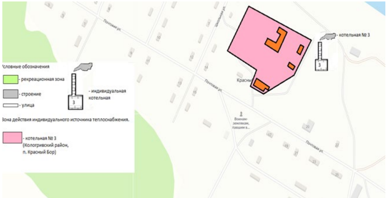
Рисунок 5. Схема индивидуального источника теплоснабжения в д. Маракино
